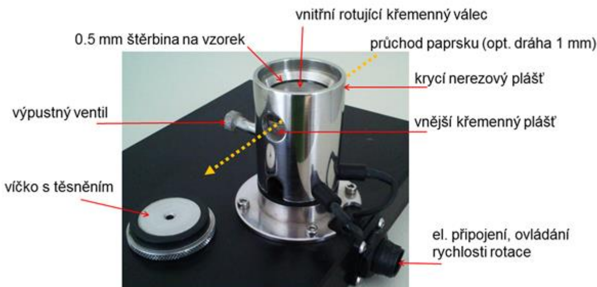
Obr. MK2: Fotografie a popis speciální rotační kyvety na měření spekter lineárního dichroismu na pracovišti autorky.
